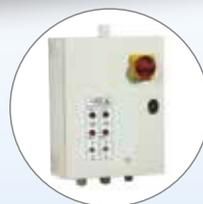
Coffret de démarrage direct des deux moteurs électriques. Il offre la possibilité de démarrer soit un seul compresseur, soit les deux avec un léger temps de décalage pour éviter une trop forte pointe d'intensité.
